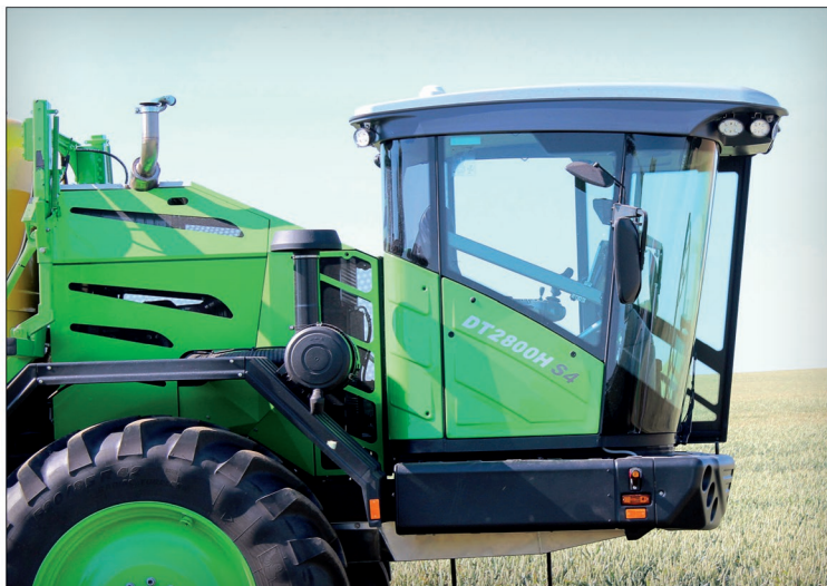
Nová kabina poskytuje obsluhu maximální komfort. Za ní je umístěn motor Mercedes Benz
