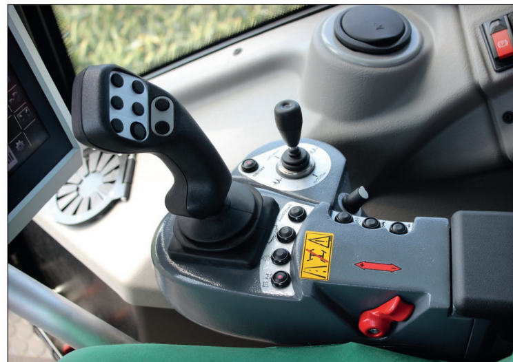
Většina funkcí včetně pojezdu se ovládá joystickem a spínači na loketní opěrce
