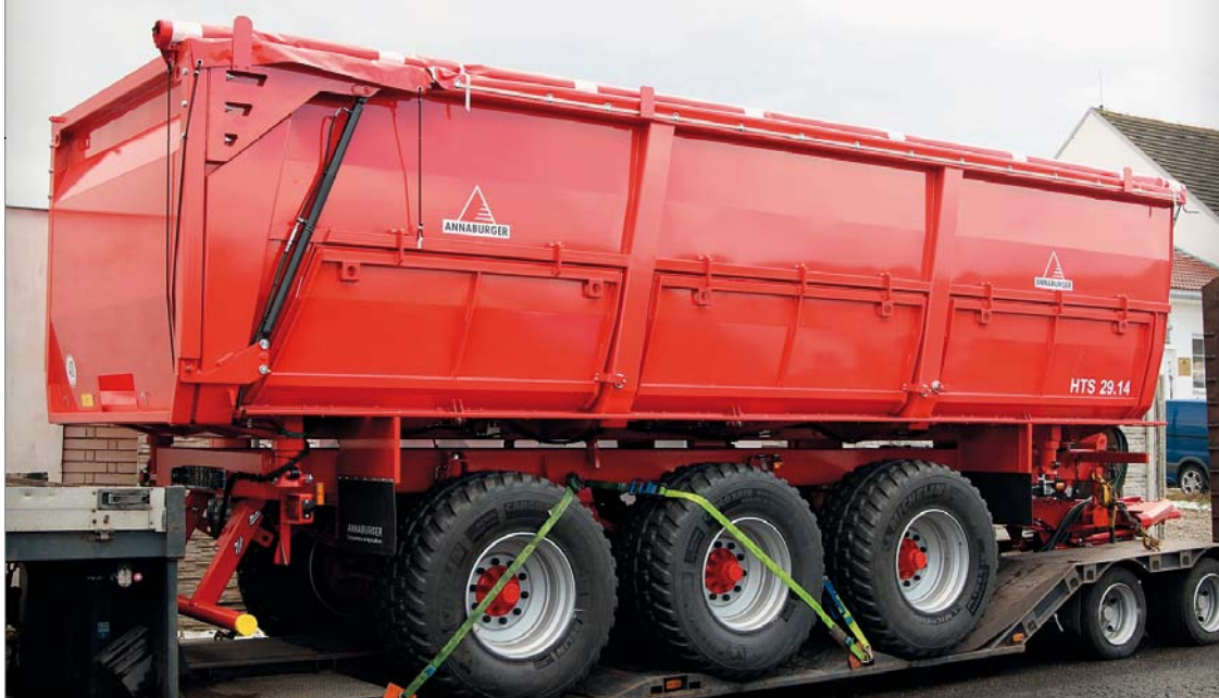
Třinápravový dvoustranný sklápěč HTS 29.14 s pneumatikami Michelin 600/55 R26,5
