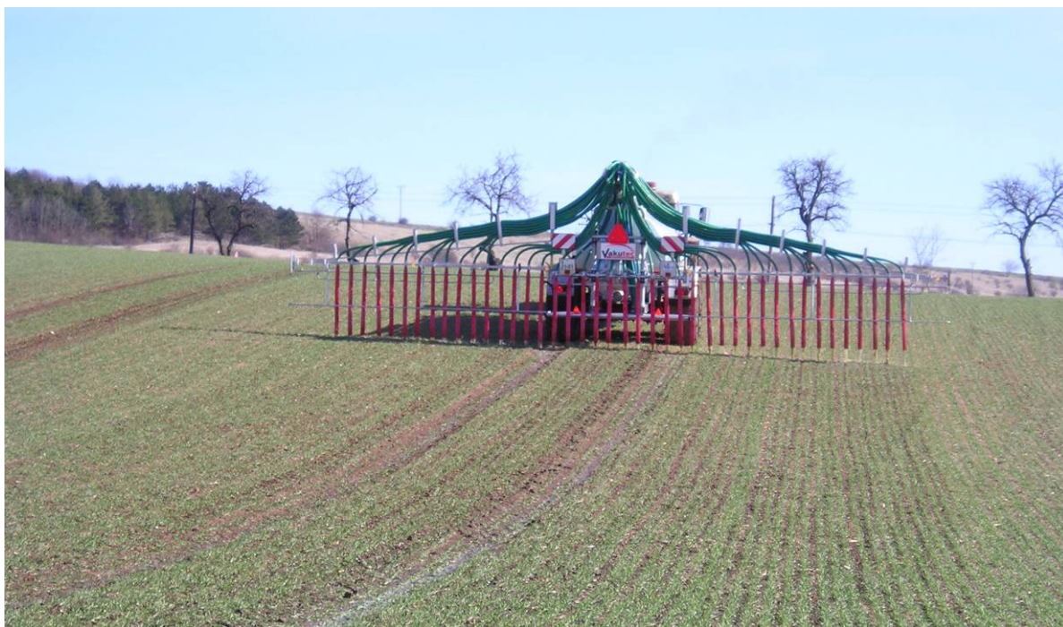
Cisterna Vakutec 12,5 m 3 na Farmě Novák –Jarpice při hnojení obilovin. Kolejové řádky 30 m, aplikátor upraven z 12 m na 10 m. První sezona 2008.
