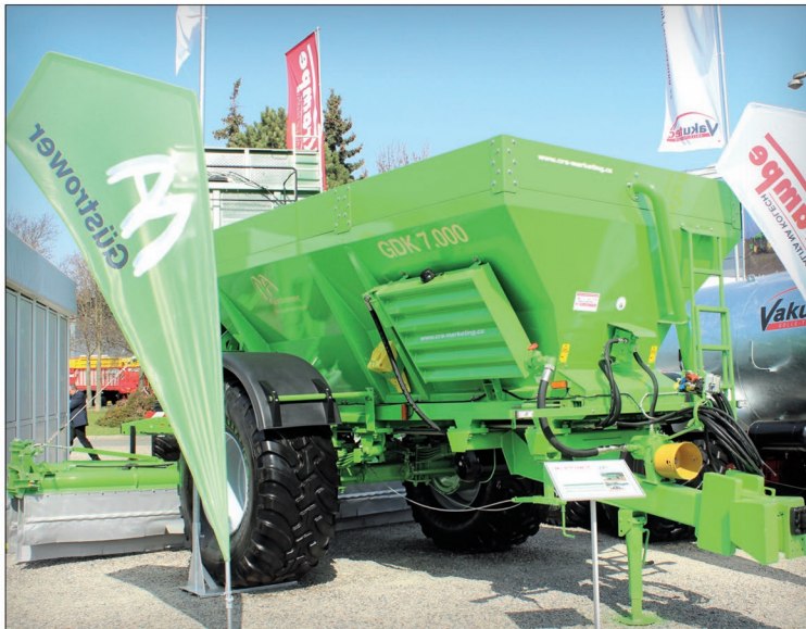
Rozmetadlo minerálních hnojiv Güstrower GDK 7.000 ve verzi s aplikačními šneky pro aplikaci vápna
